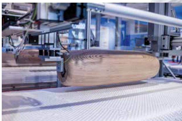
Testování mechanické odolnosti. Simulace životnosti matrace maximálním zatížením v nejexponovanější části matrace válcováním.
